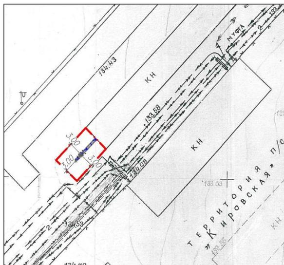
Схема планировочной организации земельного участка с учетом принятого решения об отклонении от предельных размеров
