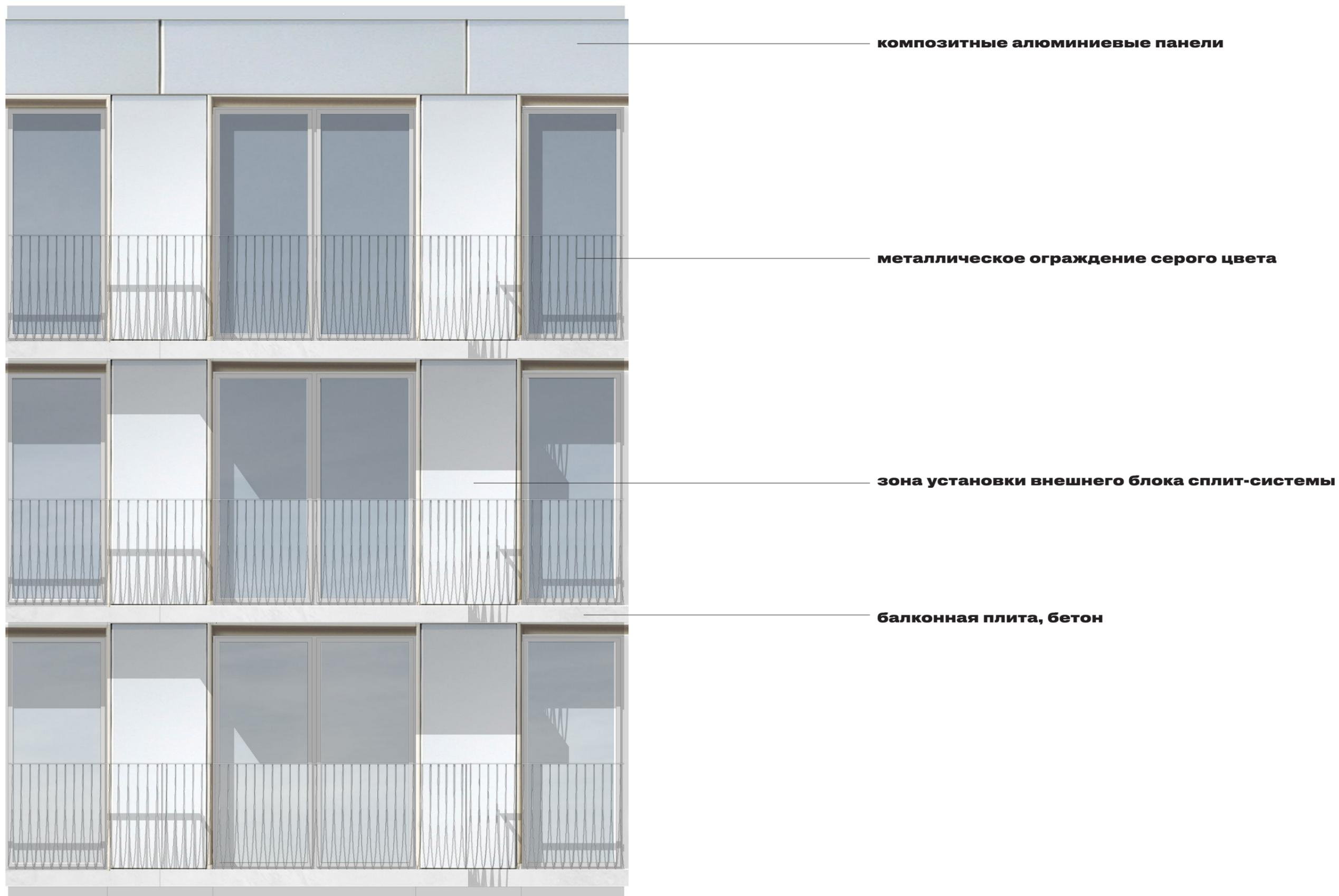
**фасад с длинными балконами. фрагмент. вариант 1**
