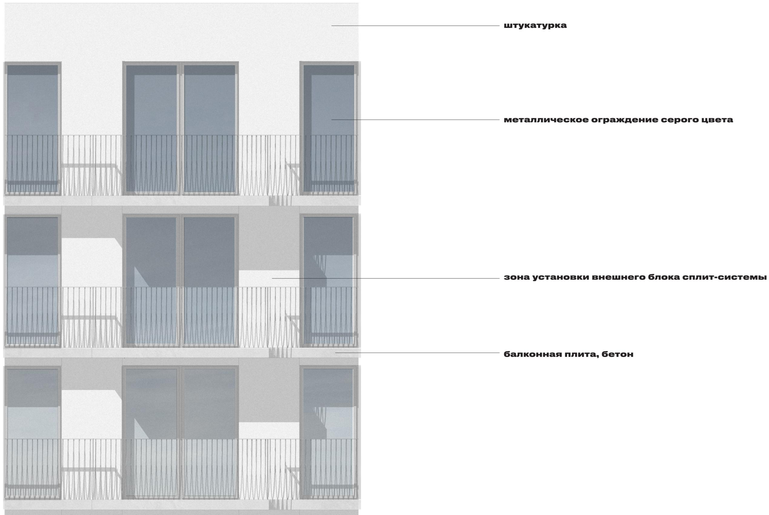
**фасад с длинными балконами. фрагмент. вариант 3**
